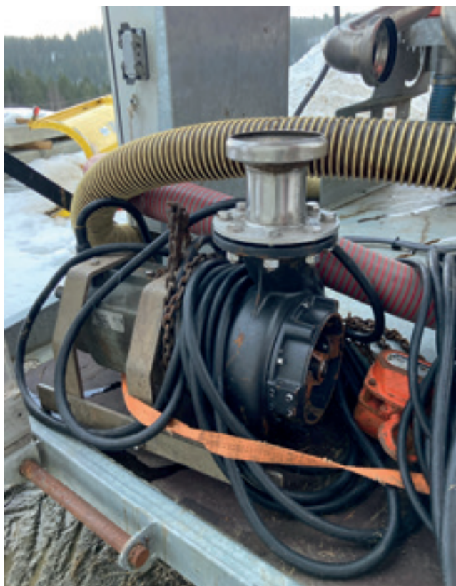
Dette er en gjødselseparator som altså gjør det enklere for mange bønder i forbindelse med spredning av naturgjødsel.
