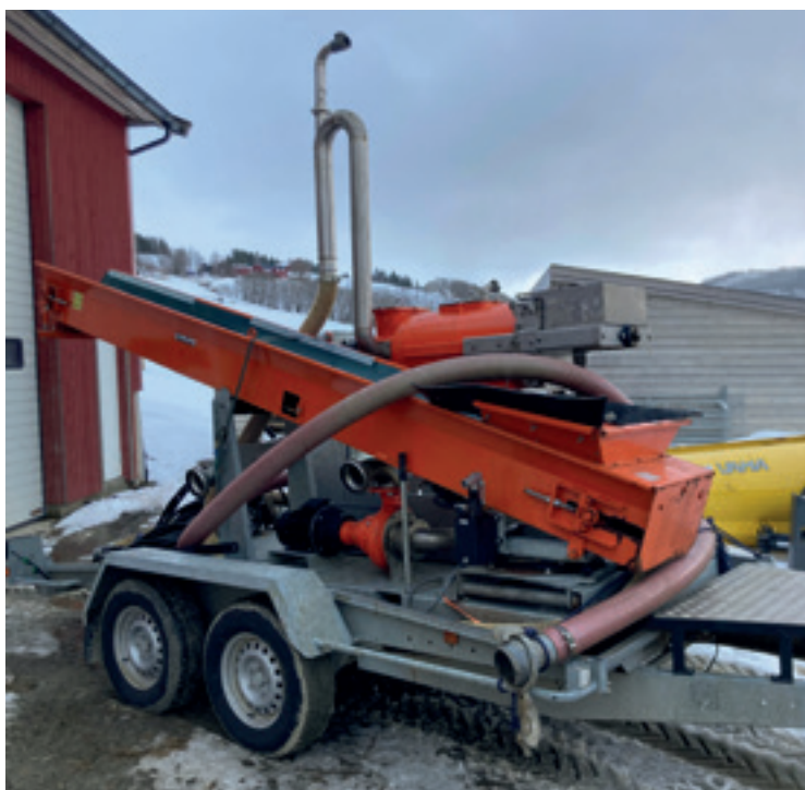
Dette er en gjødselseparator som altså gjør det enklere for mange bønder i forbindelse med spredning av naturgjødsel.
